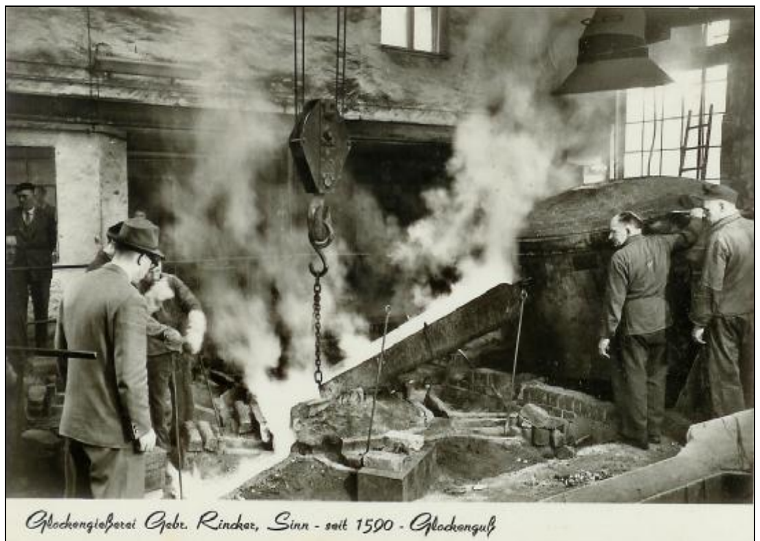
Glockengießerei Gebr. Rincker, Sinn - seit 1500 - Glockenguß Glockenguß bei Rincker 1960. Die flüssige Bronze fließt in die eingegrabenen Glockenformen
