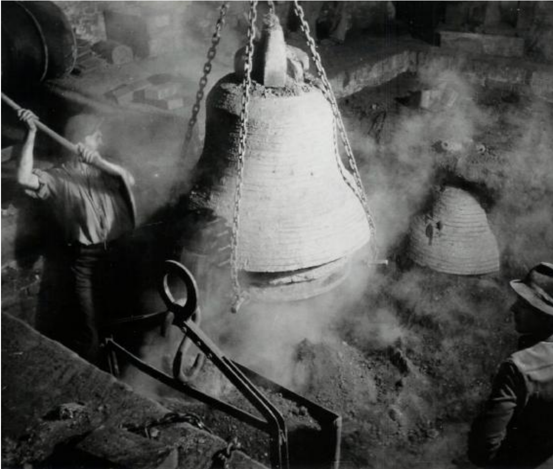
Nach dem Guß wird die gefüllte Form aus der Dammgrube gehoben, der Mantel zerschlagen.
